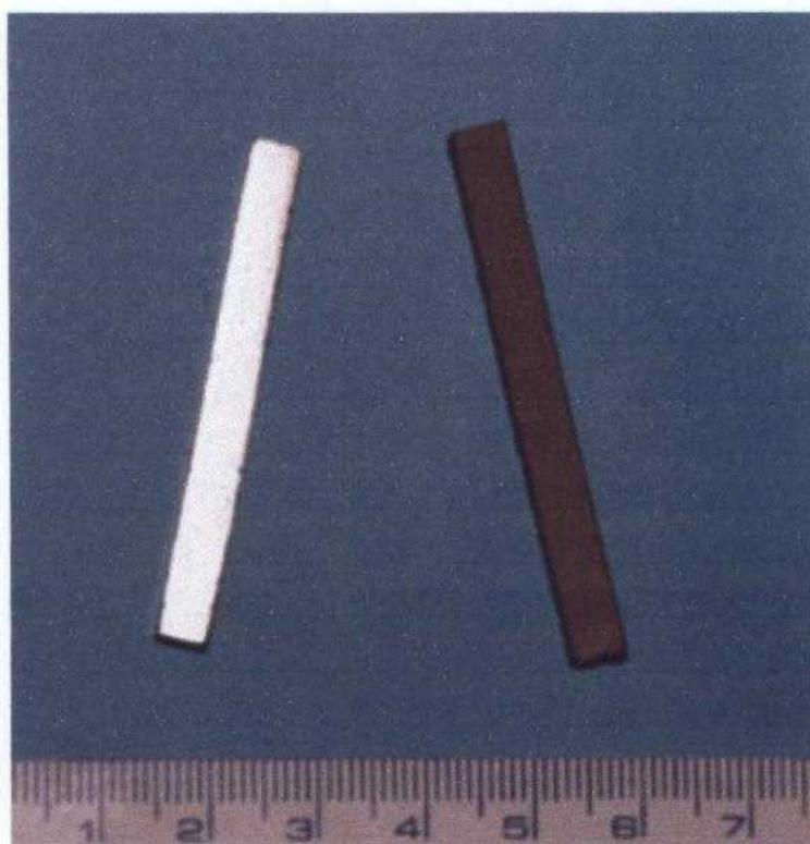
Figura 31. Peças injetadas em baixa pressão: sinterizada e a verde
