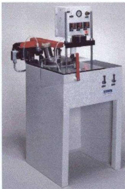
Figura 5. Injetora Peltzman, modelo MIGL-28 destinada ao processo de baixa pressão.
